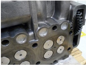
Surface d'étanchéité de la culasse avec pignon droit
