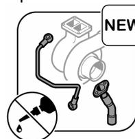
4. Remplissez le nouveau turbocompresseur d'huile moteur avant de l'installer. Pour ce faire, tournez légèrement la turbine.
